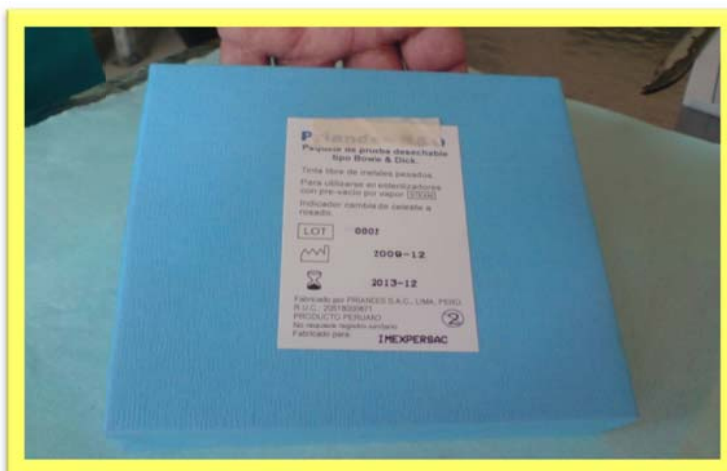
Fig.Nº21 El test de Bowie Dick son láminas o paquetes especiales que al ser procesadas detectarán fallas de expulsión de aire de la cámara.
