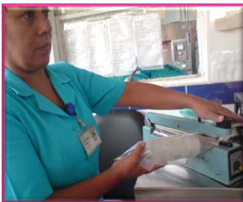
Fig.N°15 Se observa una selladora manual y diferentes empaques de plástico y Polietileno
