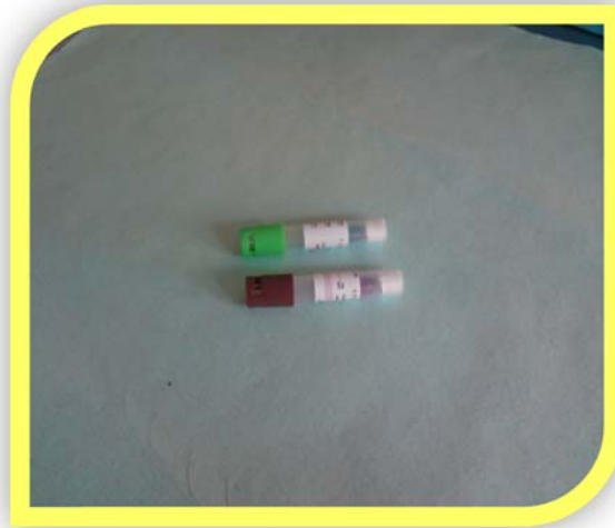
Fig.N°24 Indicadores Biológicos para autoclave
