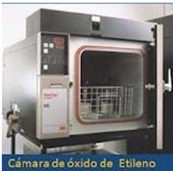
Fig. N°19: La esterilización por óxido de etileno es recomendable siempre y cuando sea automatizada.
