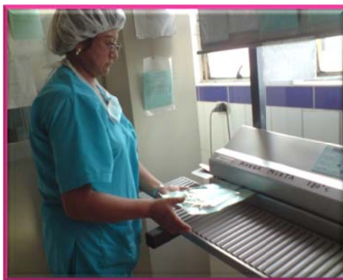
Fig.N°16 Se observa una selladora automática los empaques mixtos (Seal and peal)
